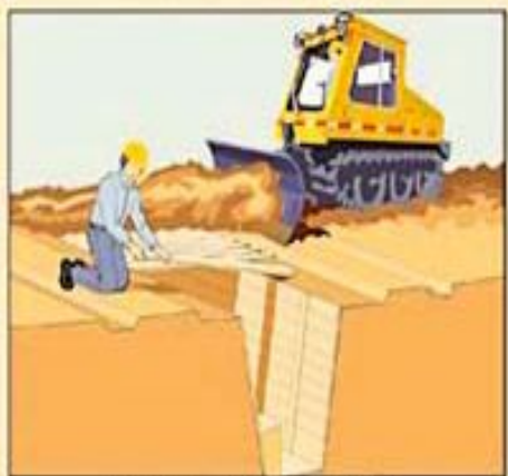
Оборудование перекрытой щели
