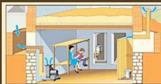
Подвал одноэтажного здания, приспособленный под противорадиационное укрытие
