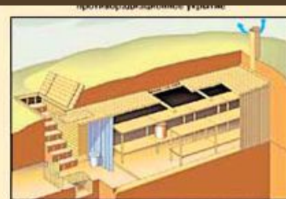
Отдельно стоящее противорадиационное укрытие из лесоматериалов
