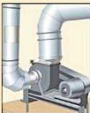
Общий вид вентилятора с электроприводом
