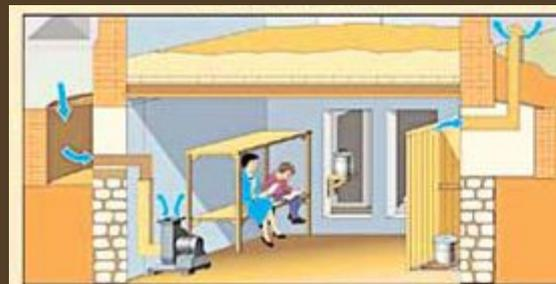
Подвал одноэтажного здания, приспособленный под противорадиационное укрытие
