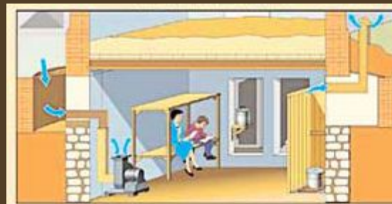
Подвал одноэтажного здания, приспособленный под противорадиационное укрытие
