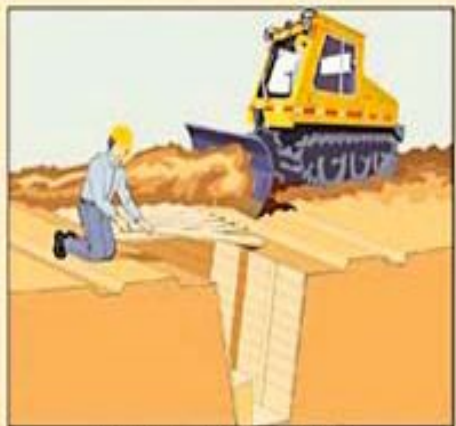
Оборудование перекрытой щели
