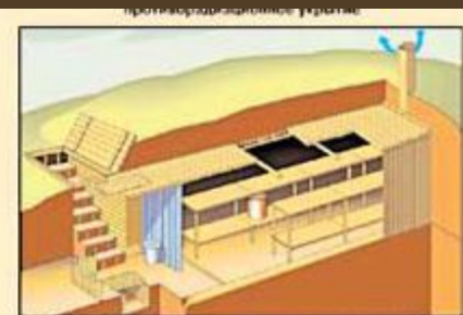
Отдельно стоящее противорадиационное укрытие из лесоматериалов
