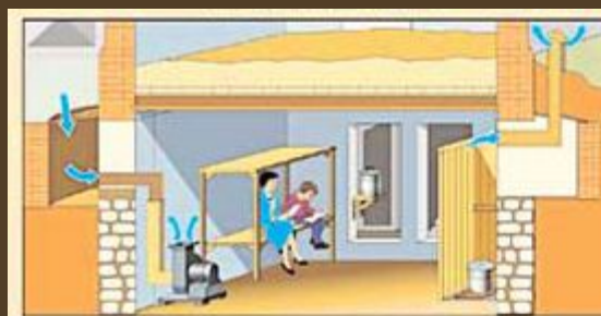
Подвал одноэтажного здания, приспособленный под противорадиационное укрытие
