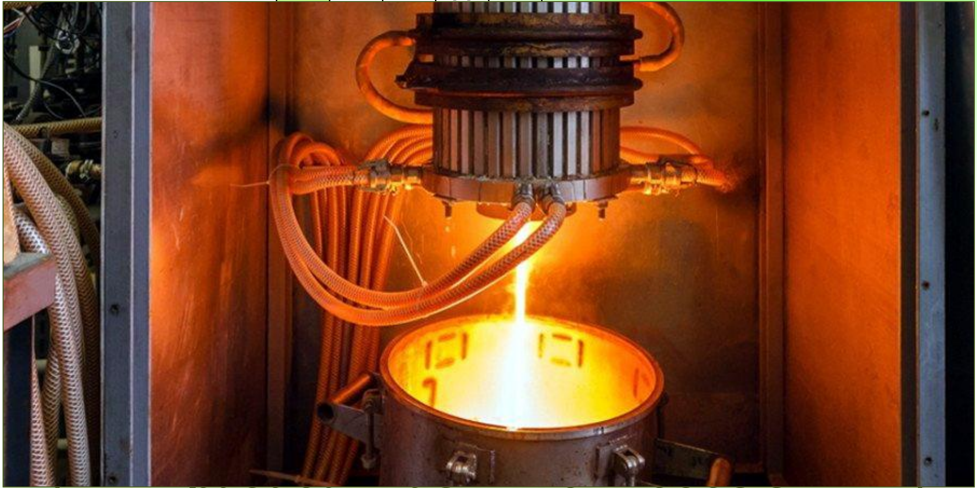
специальной вращающейся печке – кальцинаторе
