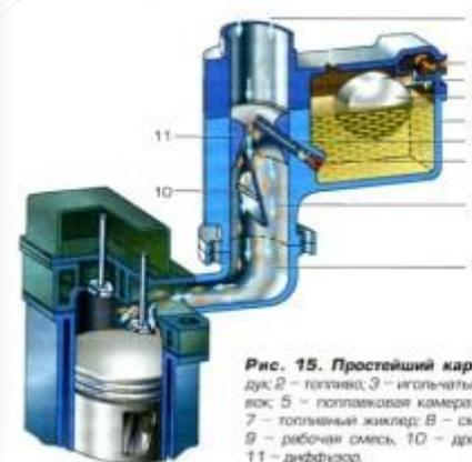
**Рис. 15. Простейший карбюратор:** 1 – воздух; 2 – топливн., 3 – игольчатый клапан; 4 – поплавок; 5 – поплавковая камера; 6 – дроссельный жиклер; 7 – топливный жиклер; 8 – смешивательная камера; 9 – рабочая смесь; 10 – дроссельная заслонка; 11 – диффузор.
