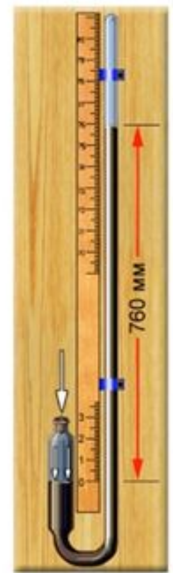
СХЕМАТИЧЕСКОЕ УСТРОЙСТВО РТУТНОГО БАРОМЕТРА
