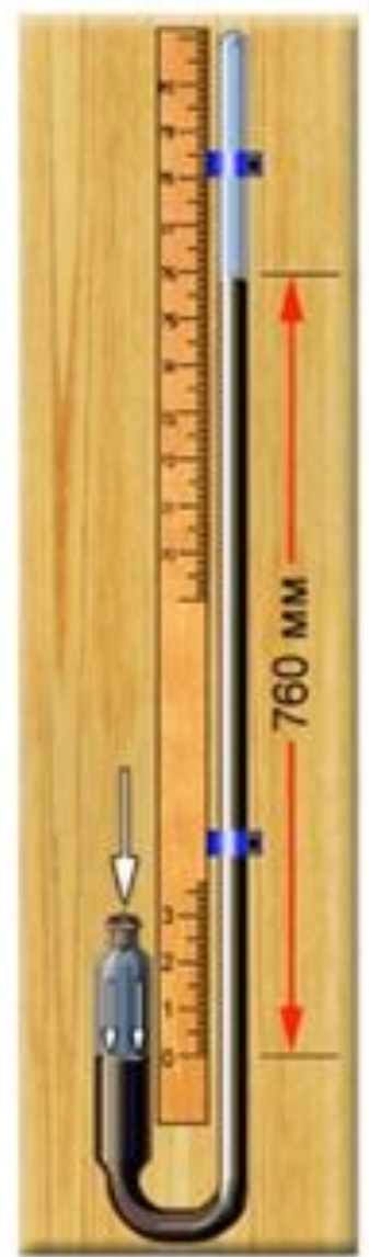
СХЕМАТИЧЕСКОЕ УСТРОЙСТВО РТУТНОГО БАРОМЕТРА
