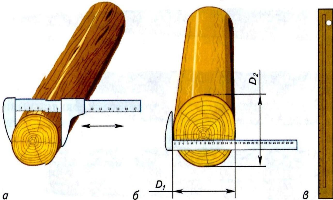
Инструменты для измерения лесоматериалов: *а* — мерная вилка; *б* — мерная скоба; *в* — метр или мерная рейка
