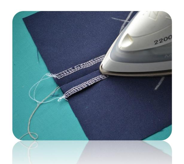
**ЗАУТЮЖИВАНИЕ.** У ШВЕЙНОГО ИЗДЕЛИЯ ПРИПУСКИ ШВА ИЛИ КРАЙ ДЕТАЛИ УКЛАДЫВАЮТ НА ОДНУ СТОРОНУ И ЗАКРЕПЛЯЮТ ИХ В ТАКОМ ПОЛОЖЕНИИ
