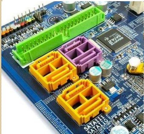
**Контроллеры SerialATA (SATA)** – новый стандарт интерфейса жестких дисков. К каждому разъему SATA подключается только одно устройство и привычная схема Master/Slave уходит в прошлое.
