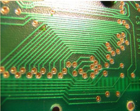
**Материнская плата** представляет собой лист стеклотекстолита покрытый медной фольгой размером примерно 25 - 30 см, с большим количеством микросхем и разъемов, к которым подключено множество проводов.
