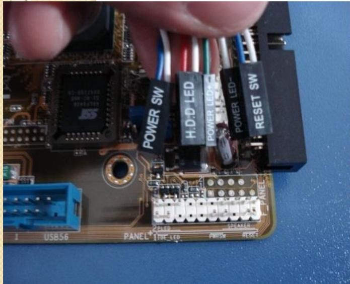
**RESET-SW** (Reset switch, RESET, RESET\_SW) - кнопка перезагрузки, обычно подходит **черный и белый провод**
