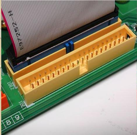
**Контроллеры IDE** – предназначены для подключения к материнской плате устройств хранения и чтения информации – жестких дисков, CD/DVD-ROM и т.д.
