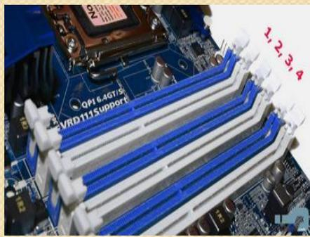
**Слотами** называют разъёмы материнской платы (или других устройств), в которые вставляются различные электронные модули и платы. Слот имеет линейку контактов, а вставляемый в него модуль - такую же линейку контактных площадок.
