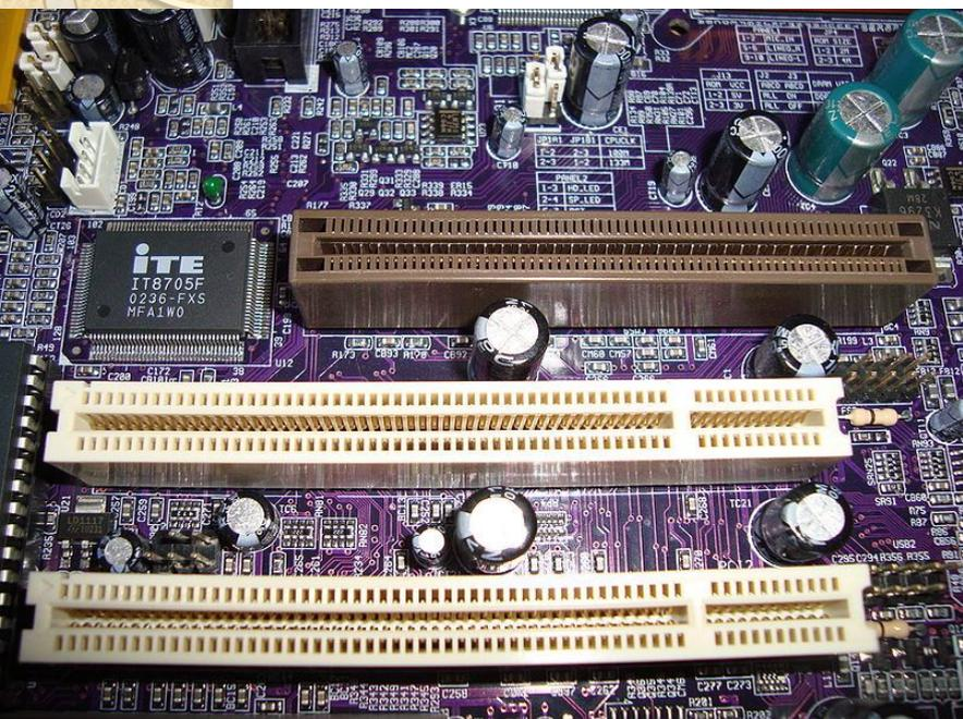
Шина PCI (Peripheral component interconnect, дословно — взаимосвязь периферийных компонентов) — шина ввода-вывода для подключения периферийных устройств к материнской плате компьютера (на рисунке слоты белого цвета).
