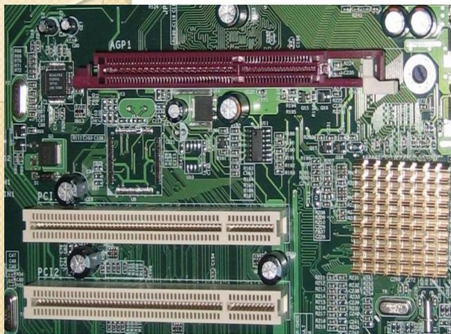
**Шина AGP ( Accelerated Graphics Port, ускоренный графический порт) — специализированная 32-разрядная системная шина для видеокарты, разработанная в 1996 году компанией Intel.**
