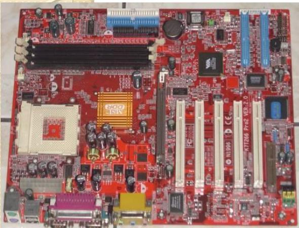
**Материнская (системная плата) Motherboard, mainboard)** — главный элемент компьютерной системы, от ее качества и быстродействия зависит быстродействие всей системы. Это самостоятельный элемент, который управляет внутренними связями и взаимодействует с внешними устройствами.
