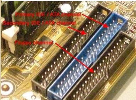
**Разъём для подключения Floppy-дисковода**
