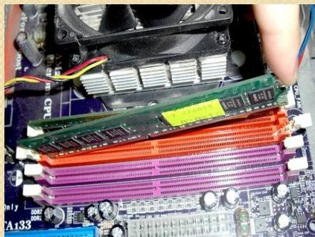
По краям слота оперативной памяти расположены пластмассовые замки, которые автоматически защёлкиваются при правильной установке. Защёлки предотвращают выпадение модуля при вибрации или перемещении системного блока.
