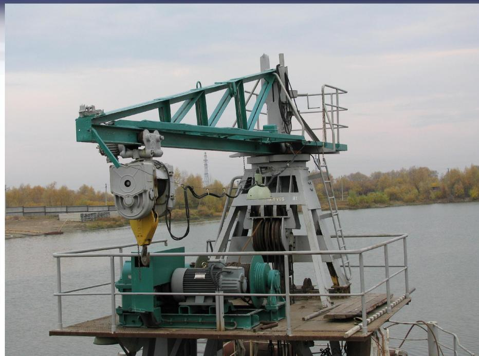
*Специальные лебедки на земснарядах устанавливаются для выполнения конкретных функций. К числу специальных относятся лебедки: рамоподъемная, лоткоподъемная, швартовная, концевая понтонного плавучего грунтопровода, грузоподъемных судовых кранов, перекладки клапанов, траловые, свайного хода земснарядов.*
