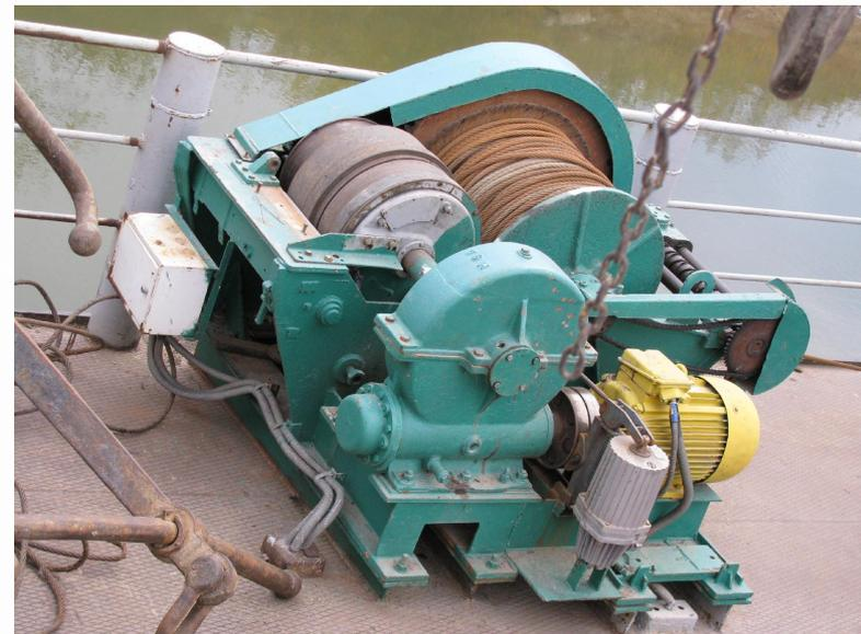
*Основное назначение оперативных лебедок — обеспечивать рабочие перемещения земснарядов на прорези в технологическом режиме производства дноуглубительных работ.*
