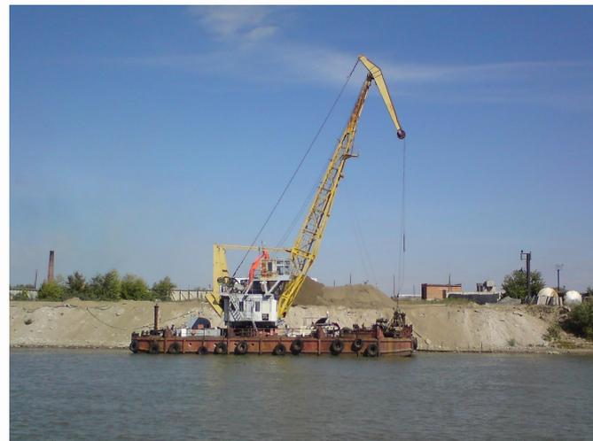
**На дноуглубительных работах применяют два типа одночерпаковых снарядов — штанговые и грейферные.**
