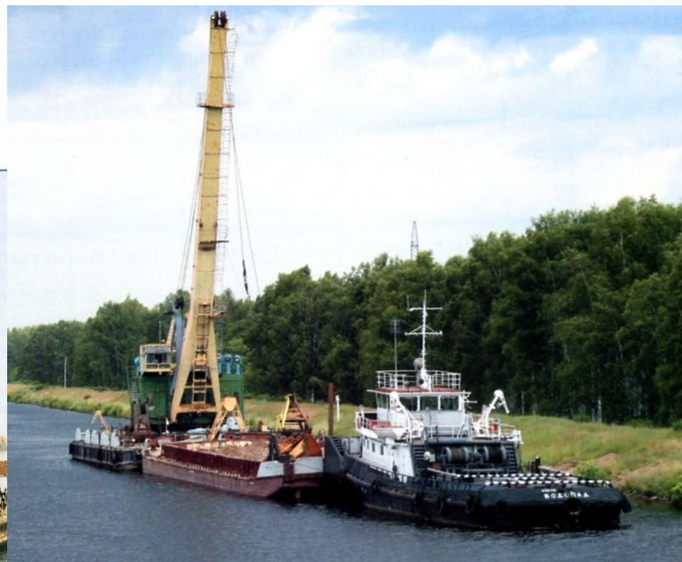
**Грейферным называется снаряд, у которого извлечение грунта со дна водоема осуществляется грейферным краном. Грейферные одночерпаковые снаряды предназначены для удаления грунтовых наносов у причальных стенок, молов, набережных, в районе гидротехнических сооружений, т. е. в тех местах, где использование снарядов другого типа невозможно или затруднено по условиям производства работ и безопасности судоходства.**
