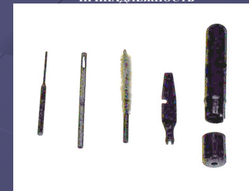
1. ВЫКОЛОТКА 2. ПРОТИРКА 3. ЕРШИК 4. ОТВЕРТКА 5. ПЕНАЛ
