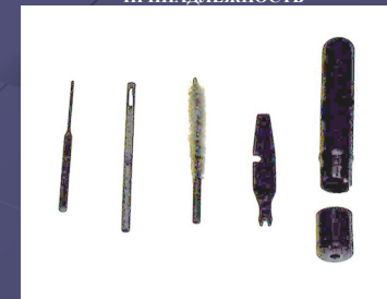
1. ВЫКОЛОТКА 2. ПРОТИРКА 3. ЕРШИК 4. ОТВЕРТКА 5. ПЕНАЛ
