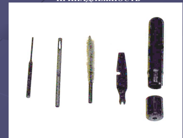
1. ВЫКОЛОТКА 2. ПРОТИРКА 3. ЕРШИК 4. ОТВЕРТКА 5. ПЕНАЛ
