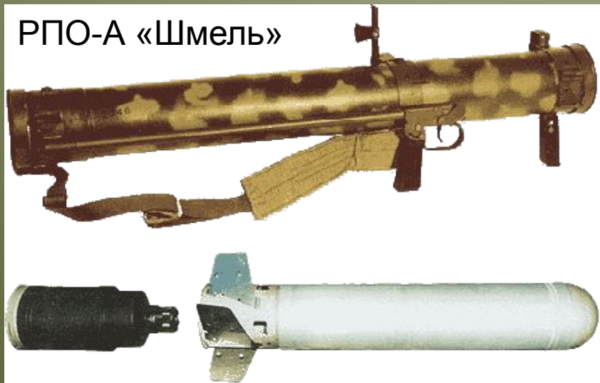
Капсула с огнесмесью и пороховой двигатель от РПО-А «Шмель»
