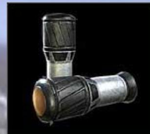
*Taser xrep* – электрическая пуля, выстреливаемая из гладкоствольного оружия 12-го калибра (вес 14 г, скорость около 90 м/с). Дальность в 3 раза больше действия ДЭШО с двумя выстреливаемыми зондами. «-»: ограниченная электрическая мощность, передаваемая в поражаемую цель, и соответственно недостаточная эффективность.
