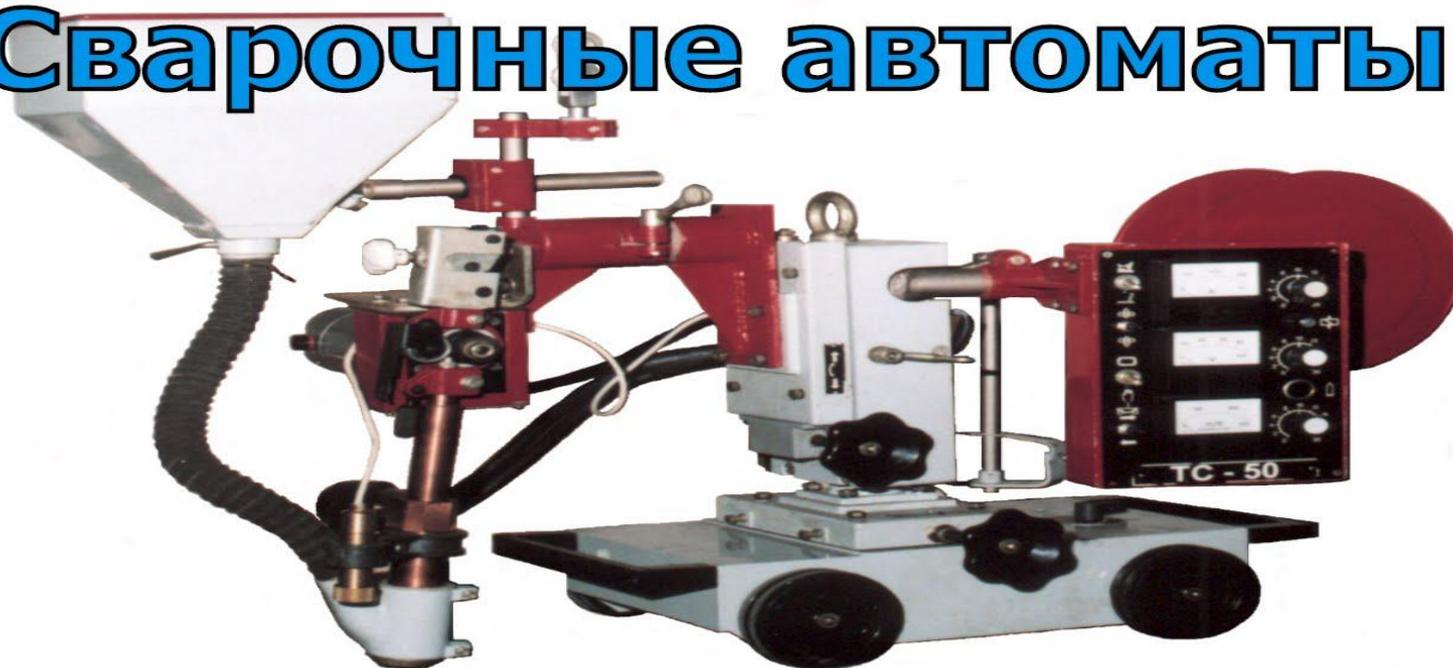
**Сварочный автомат** — механизм, который представляет собой конструктивное объединение сварочной головки с механизмом её перемещения вдоль шва, механизмами установочных перемещений, устройством для подачи флюса или защитного газа, катушками или кассетами для проволоки, пультами управления или других устройств.
