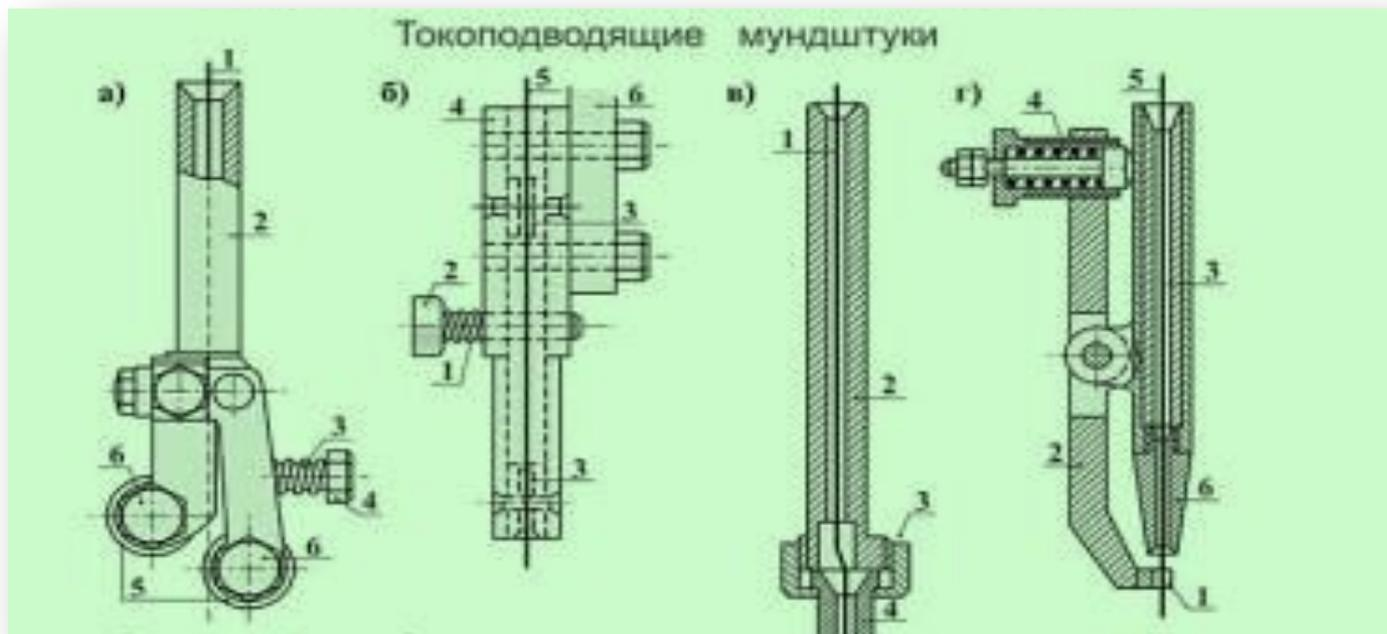
Роликовый мундштук снабжен двумя, а иногда тремя неподвижными контактными бронзовыми роликами 5 с канавками, между которыми скользит сварочная проволока 1. Ролики укреплены на токоведущем корпусе 2 и при помощи винта 4 сжимаются пружинами 3. По мере износа контактные ролики поворачивают на некоторый угол до восстановления хорошего электрического контакта и закрепляют в новом положении болтами 6.
