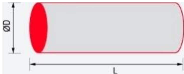
Цилиндрические слитки, ЭШП D=160-240 мм; L=600-1200 мм Масса: 95-444 кг
