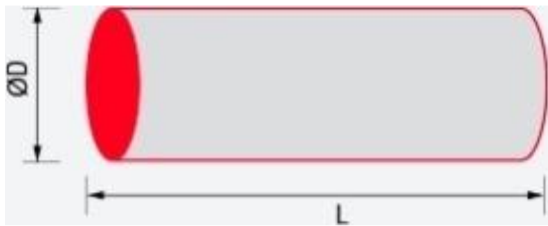
Цилиндрические слитки D=360-582 мм; L=1321-2030 мм Масса: 950-4525 кг
