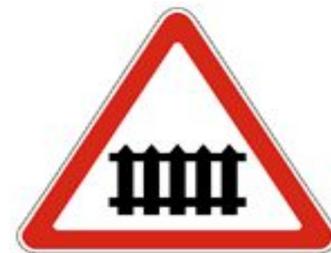
1.1 Железнодорожный переезд со шлагбаумом
