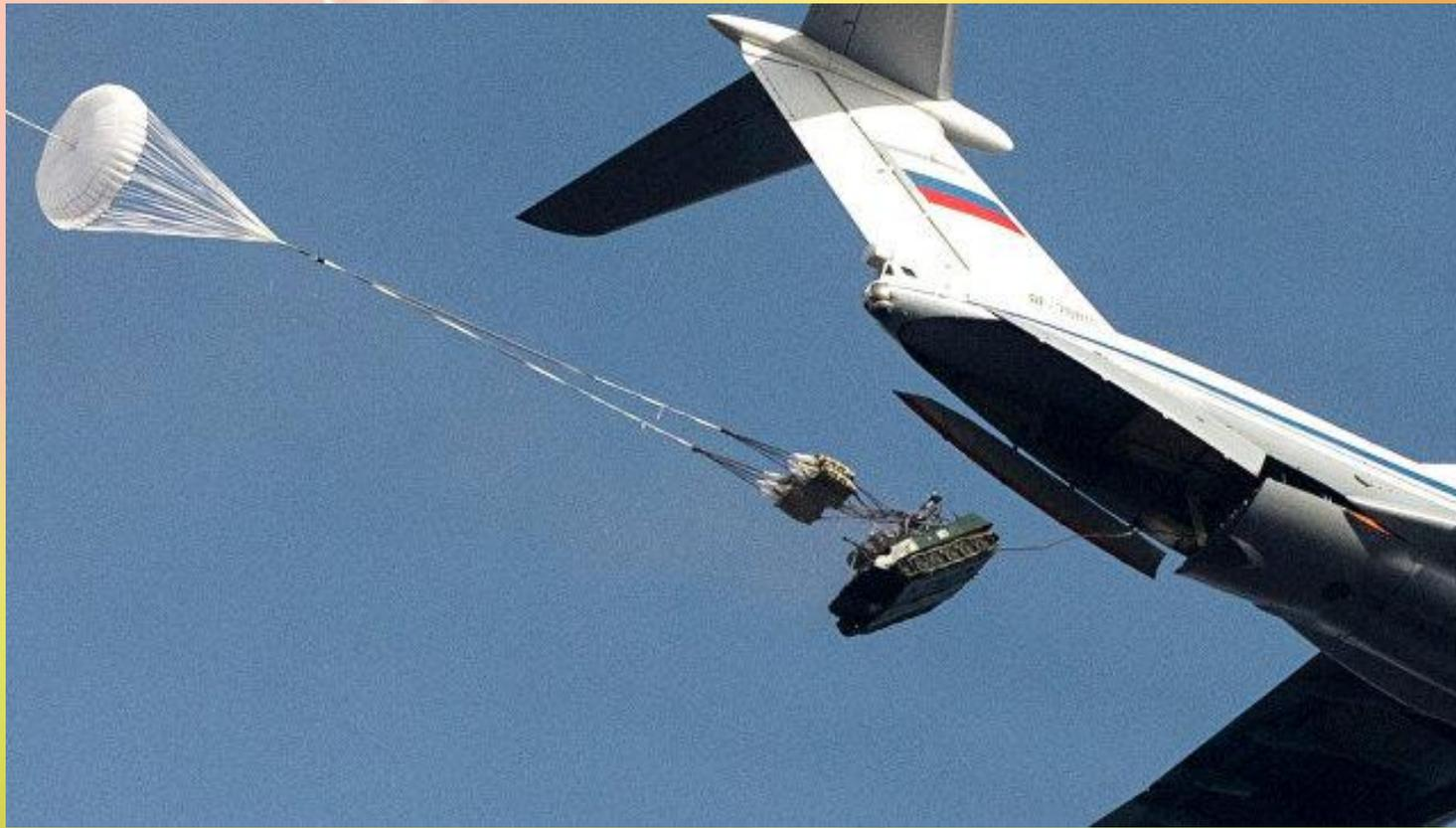
Бионические принципы получили наиболее яркое и комплексное воплощение в конструкции отечественной боевой машины десанта (БМД), что позволяет ей успешно действовать в трех средах - в воздухе, на земле и в воде. С помощью специально разработанной системы БМД выбрасывается из транспортного самолета на парашюте и, подобно семенам растений, безопасно опускается на землю.
