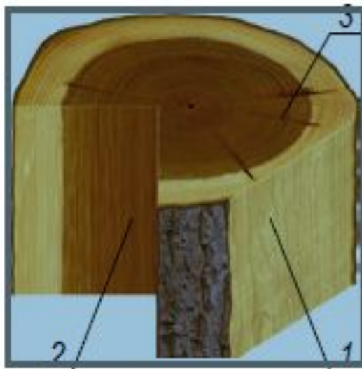
Рис. 22. Основные разрезы ствола дерева: 1 – тангенциальный; 2 – радиальный; 3 – поперечный (торцевой)
