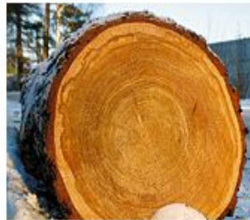
Рис. 23. Годовые кольца на поперечном разрезе ствола
