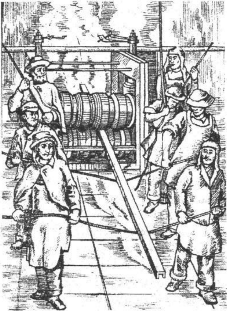
Рис. 4. Старинный сортопрокатный стан
