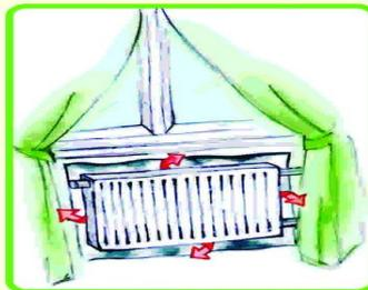
**Между радиаторной батареей и стеной установите защитный экран из алюминиевой фольги. Фольга отражает тепло и направляет его обратно в комнату (экономия до 4%)**
