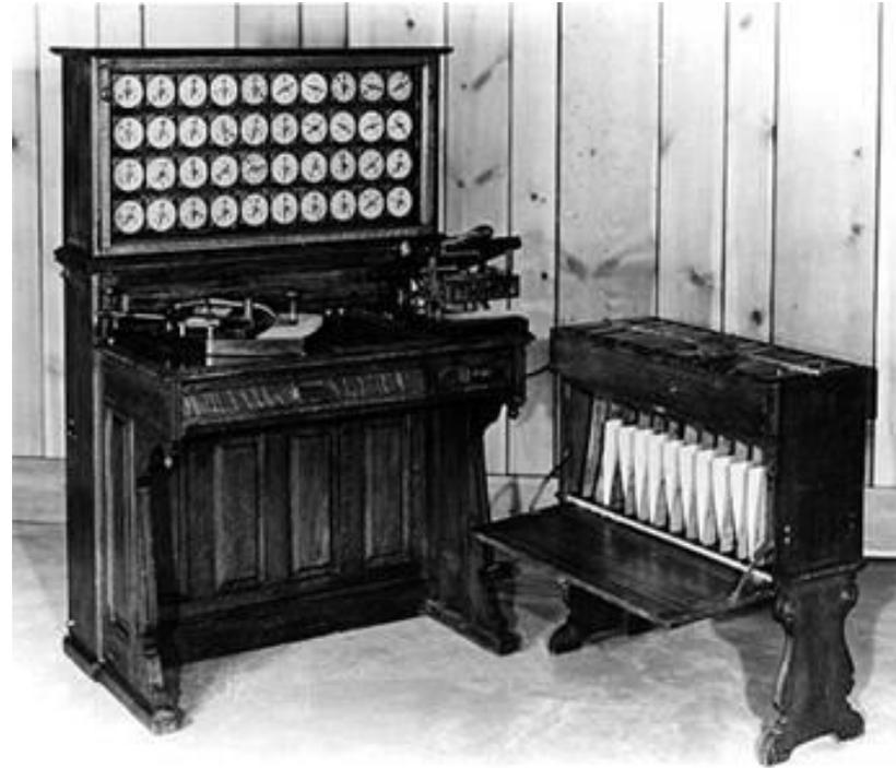
**Табулятор** - электромеханическое устройство
