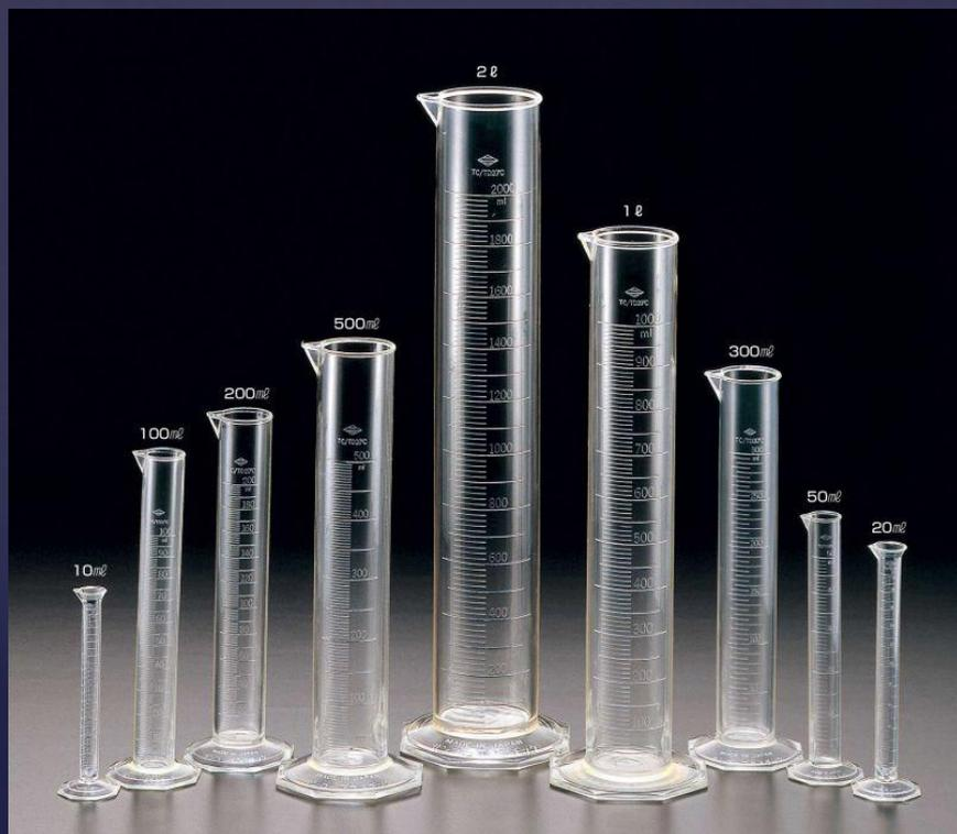
*Мерные цилиндры* – стеклянные толстостенные сосуды с нанесенными на внешней стенке делениями, указывающими **ВМЕСТИМОСТЬ**
