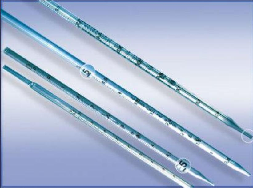
Пипетка применяется для точного измерения определенного объёма раствора и перенесения его из одного сосуда в другой.
