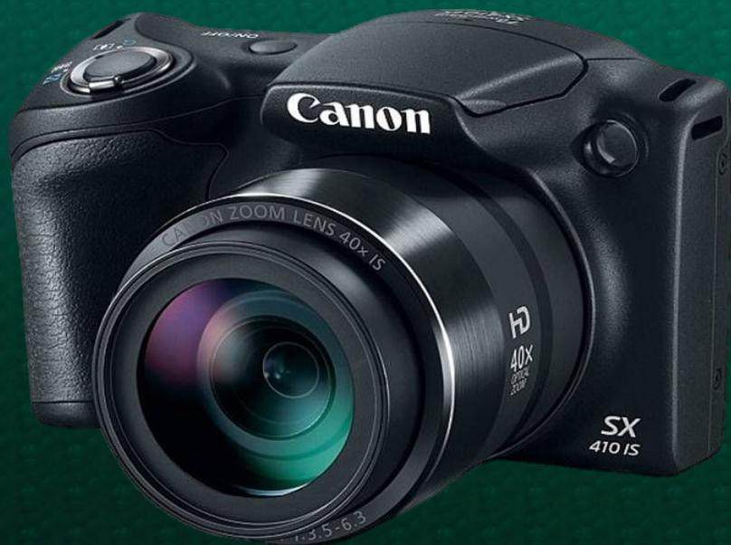
Как и сканеры, эти устройства воспринимают графические данные с помощью приборов с зарядовой связью, объединенных в прямоугольную матрицу.
