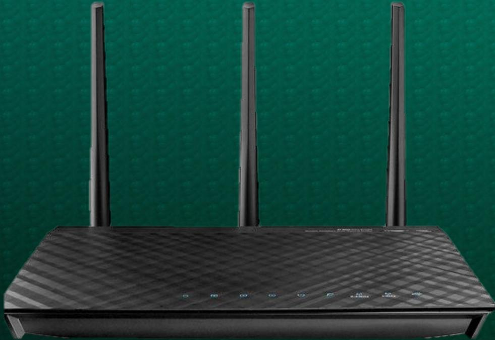
Если кратко, то роутер, это устройство, которое распределяет интернет между подключенными к нему устройствами. По сетевому кабелю (компьютеры, телевизоры и т. д.), или по Wi-Fi (смартфоны, планшеты, ноутбуки).
