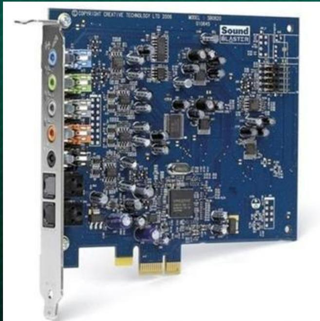
Звуковая карта выполняет операции, связанные с обработкой звука, речи, музыки. Звук воспроизводится через колонки (наушники), подключаемые к выходу звуковой карты. Имеется также разъем для подключения микрофона. Основным параметром ЗК является разрядность, чем выше разрядность, тем меньше погрешность, связанная с оцифровкой, тем лучше звучание.
