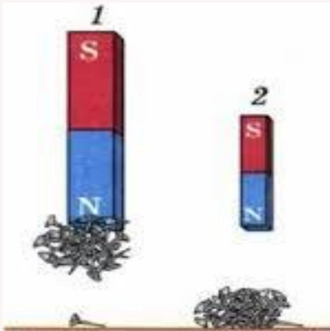
При одном и том же расстоянии до гвоздей, сила притяжения к первому магниту оказалась достаточной для преодоления силы тяжести гвоздей, а сила притяжения ко второму – нет.
