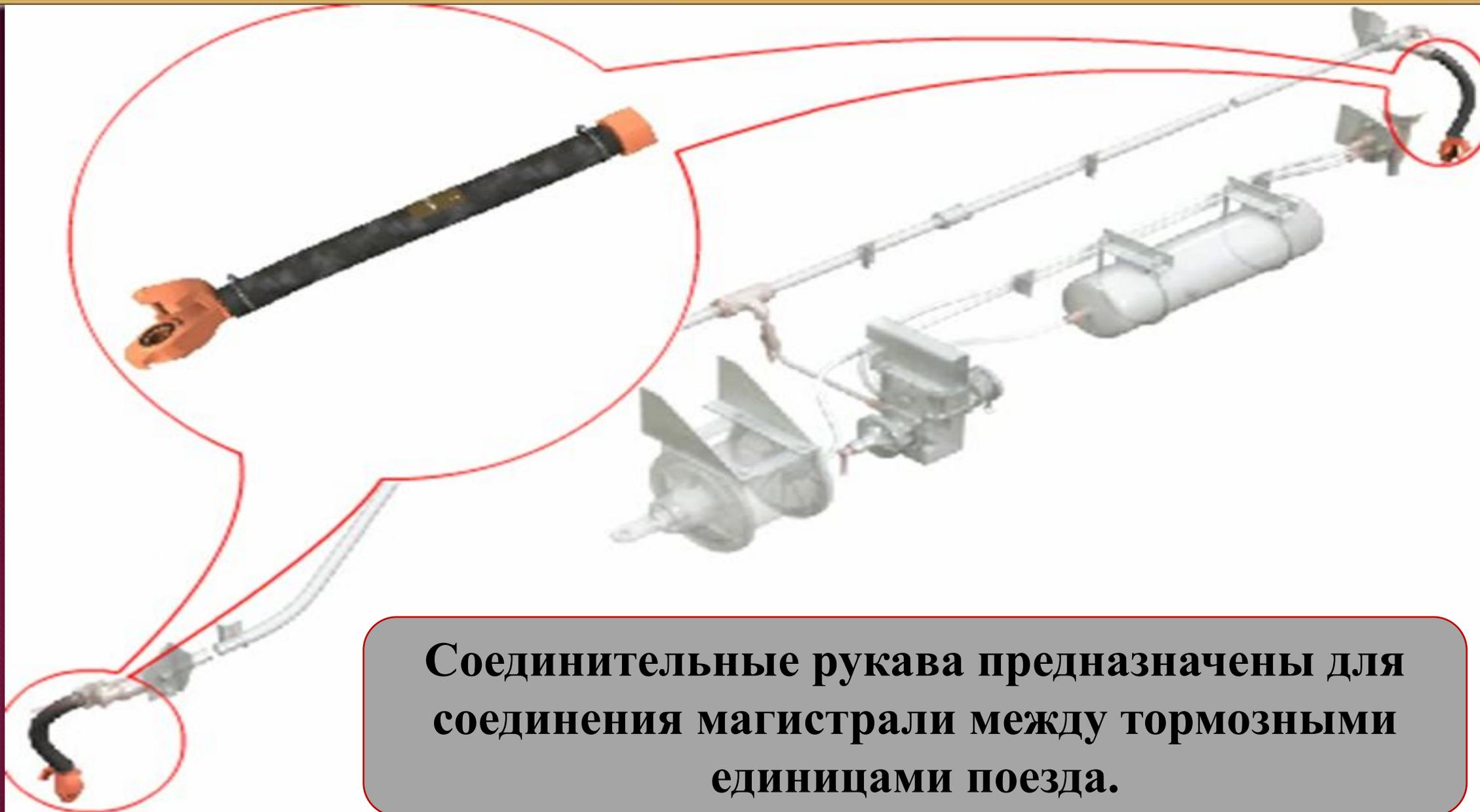
**Соединительные рукава предназначены для соединения магистрали между тормозными единицами поезда.**
