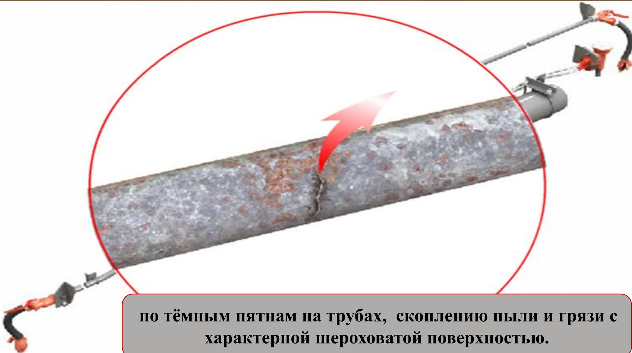
**по тёмным пятнам на трубах, скоплению пыли и грязи с характерной шероховатой поверхностью.**
