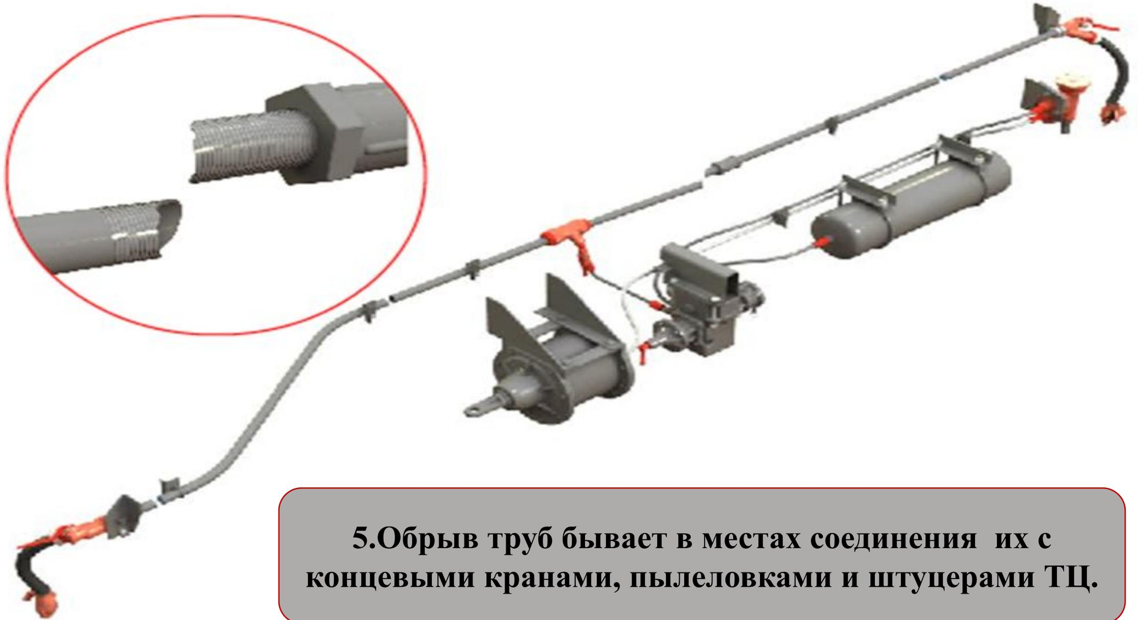
**5. Обрыв труб бывает в местах соединения их с концевыми кранами, пылеловками и штуцерами ТЦ.**
