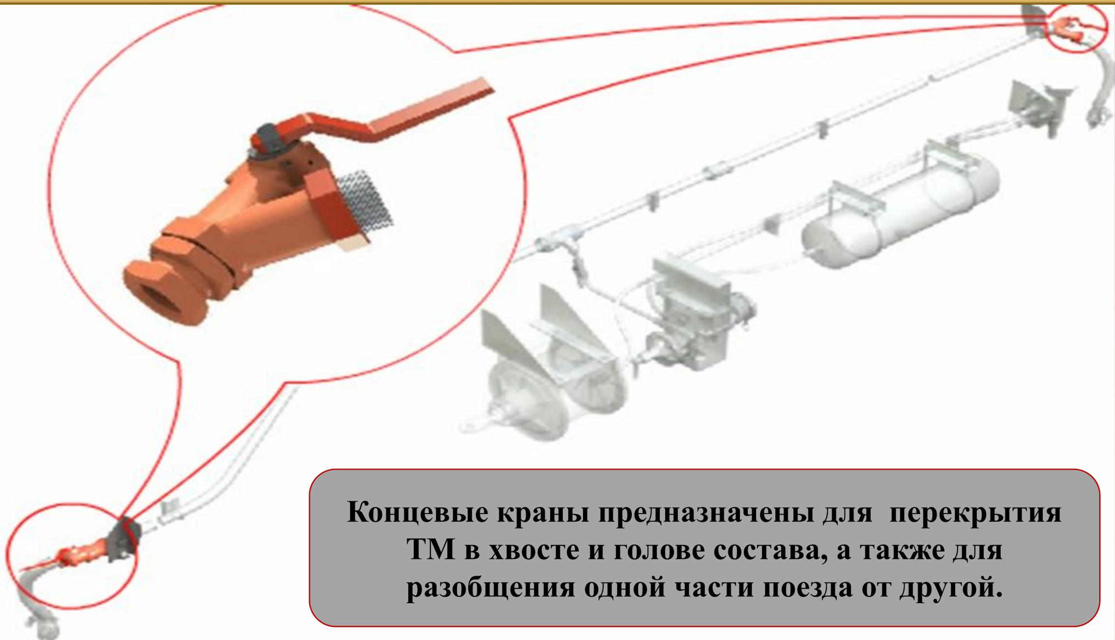
**Концевые краны предназначены для перекрытия ТМ в хвосте и голове состава, а также для разобщения одной части поезда от другой.**
