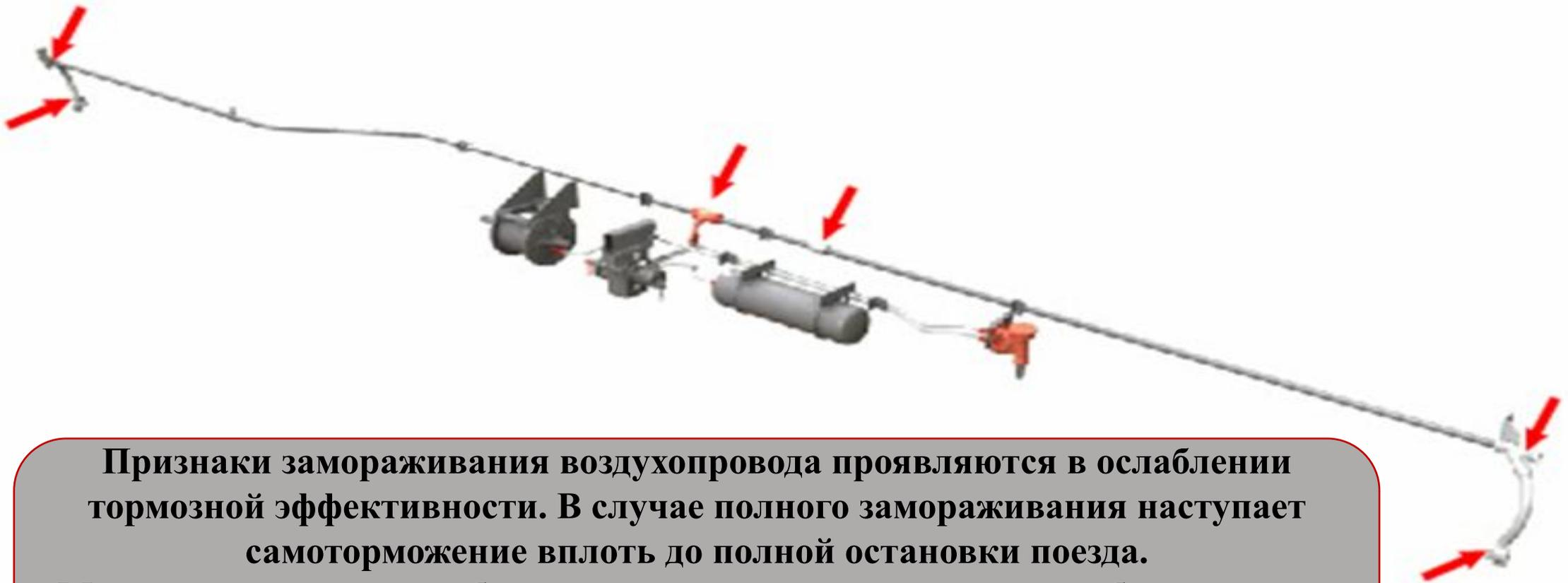
**Признаки замораживания воздухопровода проявляются в ослаблении тормозной эффективности. В случае полного замораживания наступает самоторможение вплоть до полной остановки поезда.**
