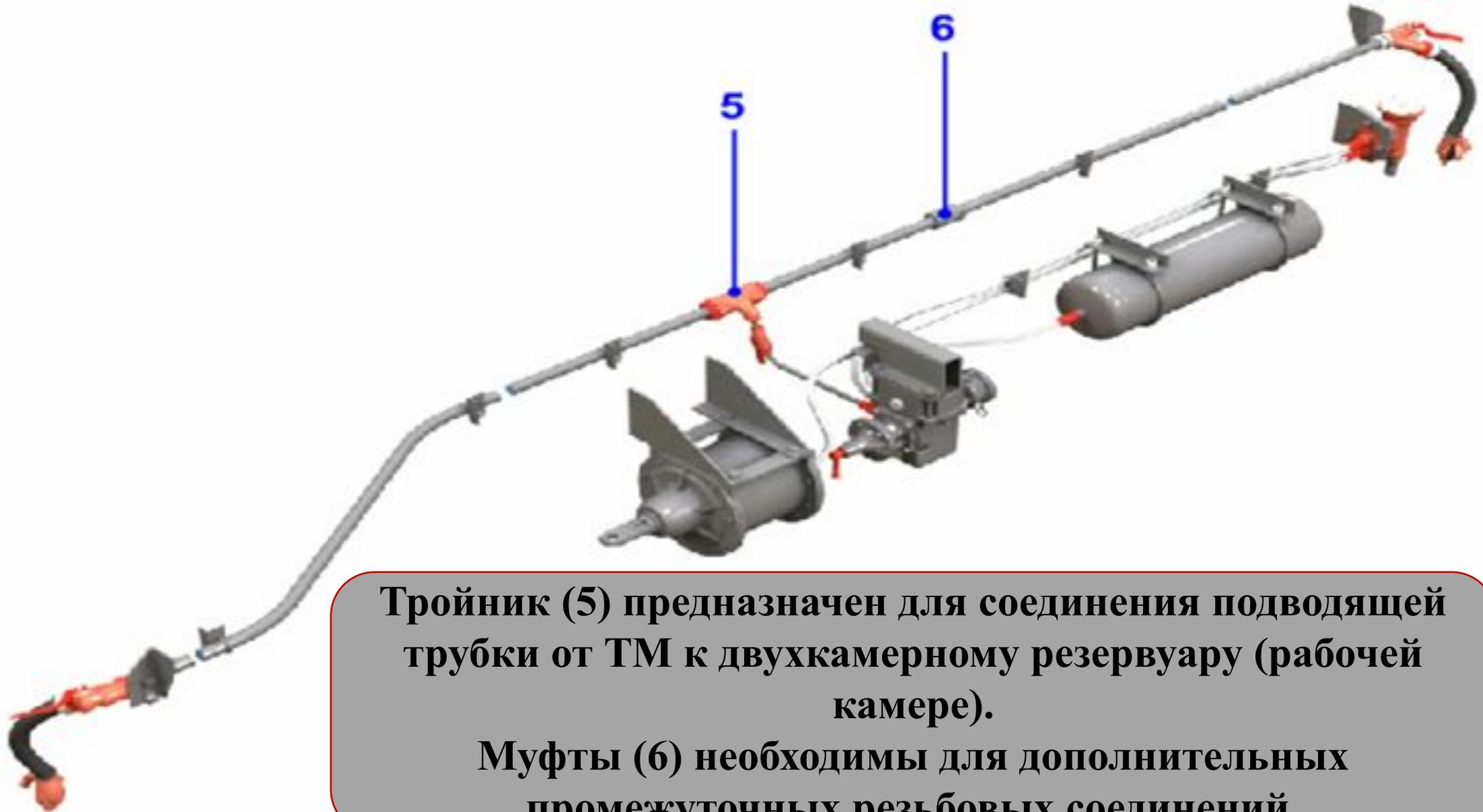
**Тройник (5) предназначен для соединения подводящей трубки от ТМ к двухкамерному резервуару (рабочей камере).**
