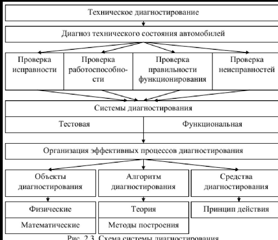
Рис. 2.3. Схема системы диагностирования
