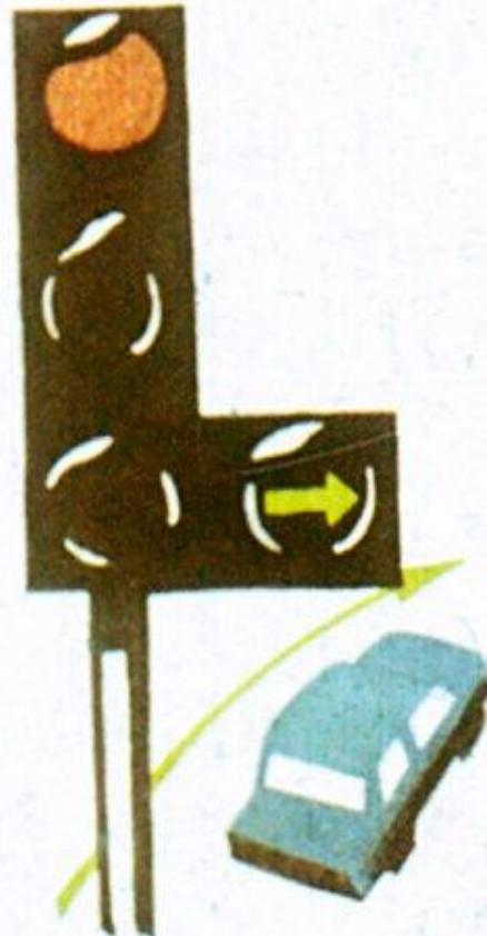
Для регулирования дорожного движения наряду со знакомыми вам трехсекционными светофорами применяются трехсекционные светофоры, оборудованные дополнительными секциями со стрелкой, которая указывает направление движения.
