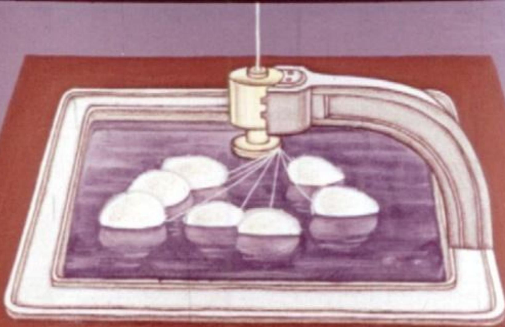
Ноны тонюсеньких шелковинок вставляют в мотальную машину. Чем больше шелковинок, тем толще будет нить. Длина шелковинки одного конона превышает километр.
