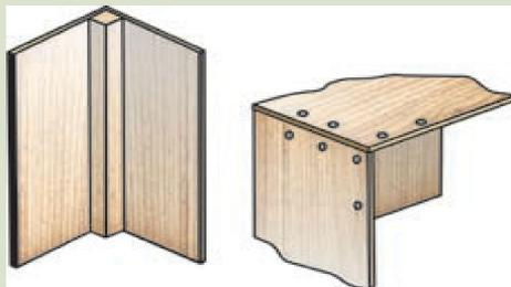
Детали из фанеры соединяют на угол при помощи скрепляющего бруска.
