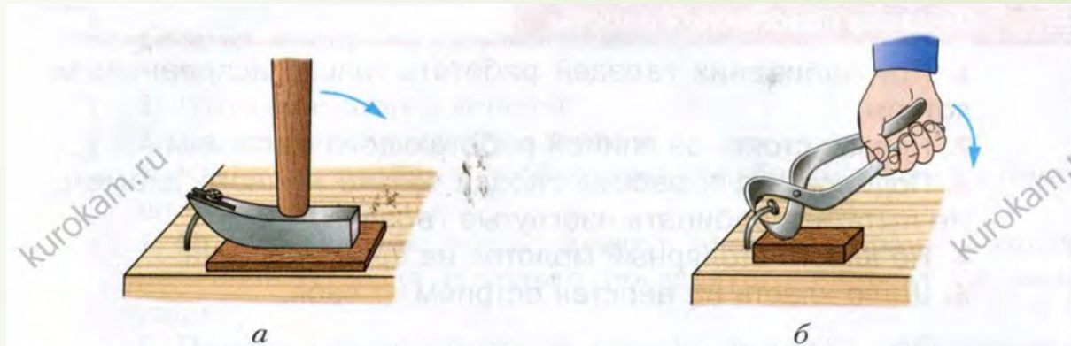
Рис. 51. Приёмы вытаскивания гвоздей: а — молотком; б — клещами
