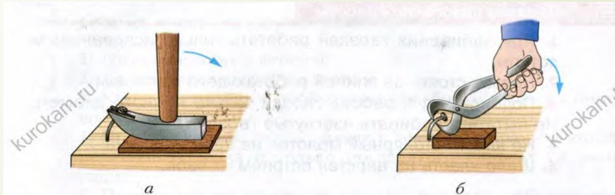
Рис. 51. Приёмы вытаскивания гвоздей: *а* — молотком; *б* — клещами
