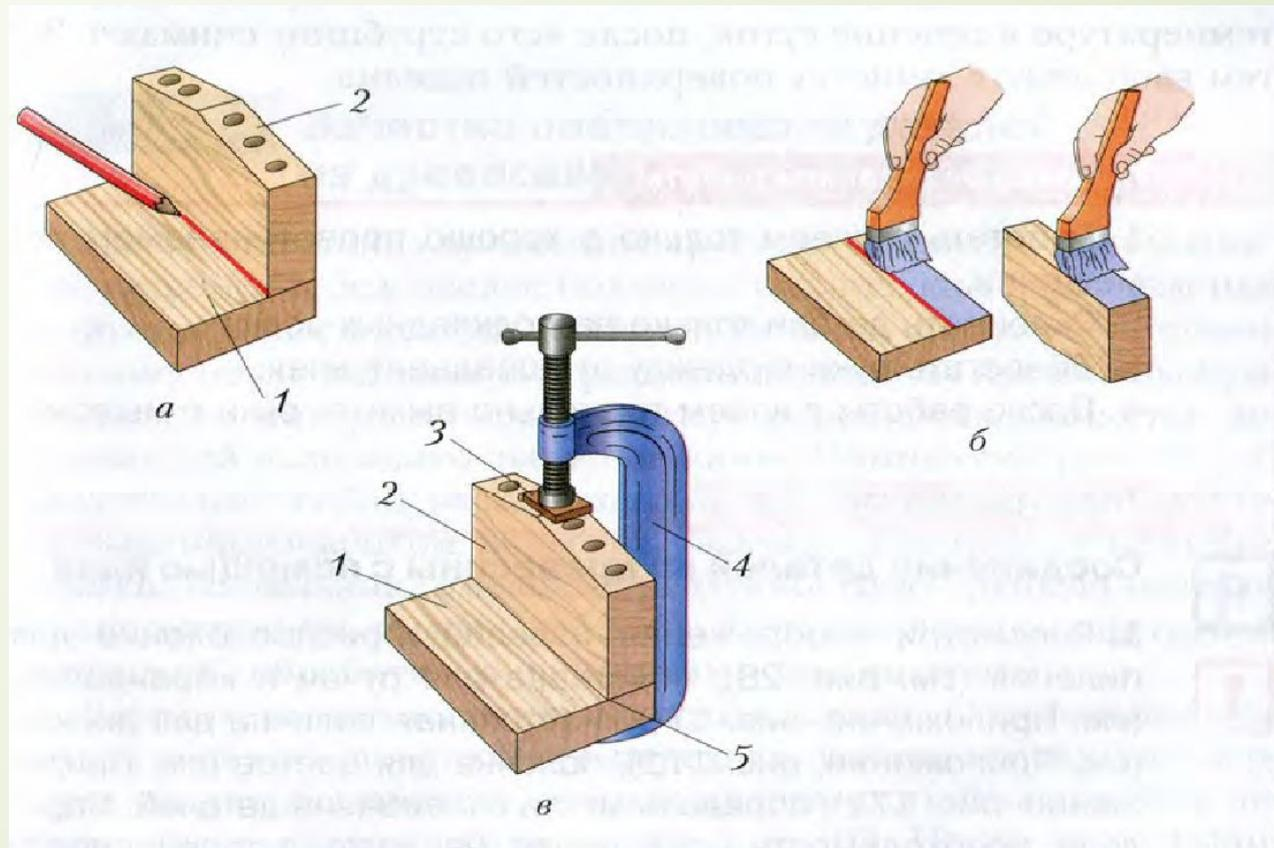
Рис. 59. Соединение деталей клеем: *а* — разметка границы склеивания; *б* — нанесение клея на детали; *в* — сжатие деталей в струбцине; 1 — основание; 2 — карандашница; 3 — подкладной брусок; 4 — струбцина; 5 — клеевой шов
