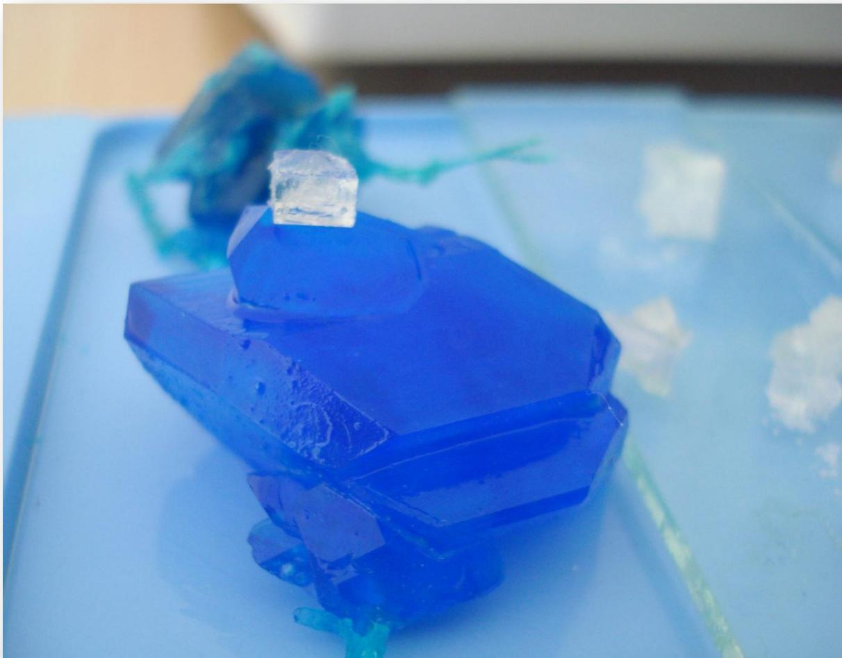
*Существуют два простых способа выращивания кристаллов из пересыщенного раствора: путем охлаждения насыщенного раствора или путем его выпаривания.*
