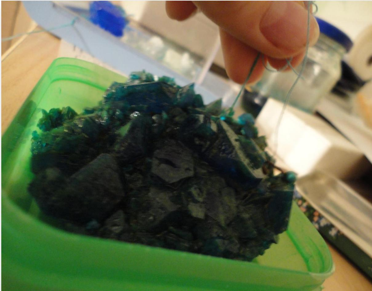
*Если выращивание одиночных кристаллов занимает много времени и рассчитано на постепенный, правильный рост кристаллов, то выращивание друзы гораздо легче, потому что оно ориентируется на быстрое, хаотическое выпадение кристаллов.*
