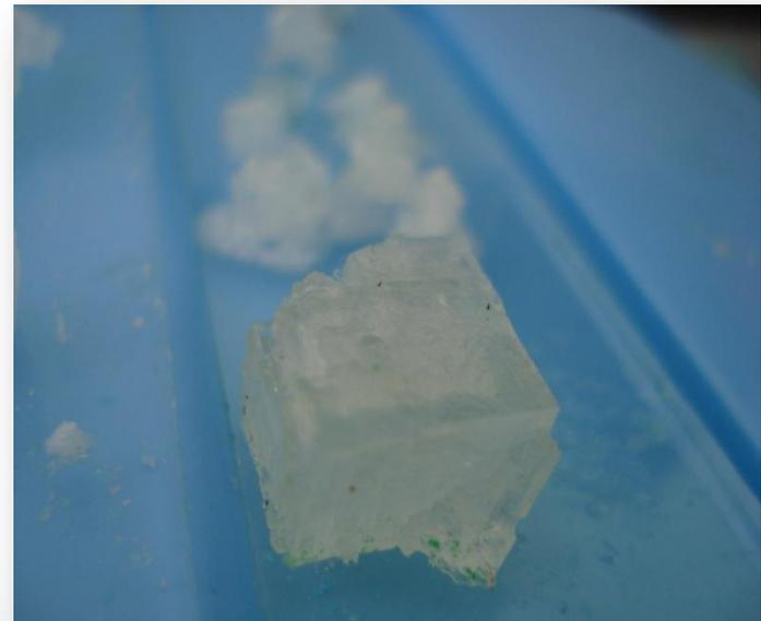
*После охлаждения раствора в него вносят затравку – подвешенный на ниточке кристаллик. Уже через 5-10 часов можно увидеть большое количество кристалликов на нитке, на затравке, на дне стакана.*
