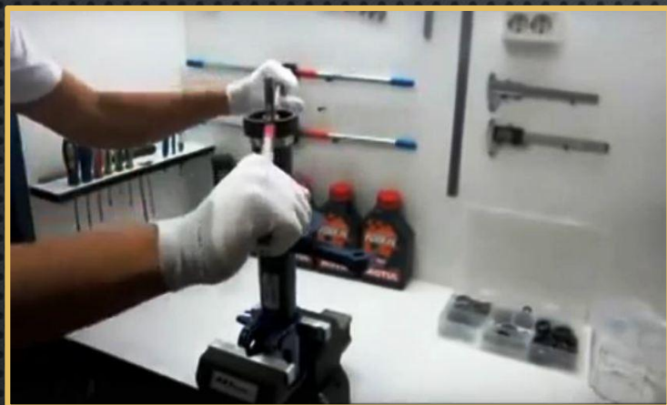
1. Установить амортизатор в тиски
