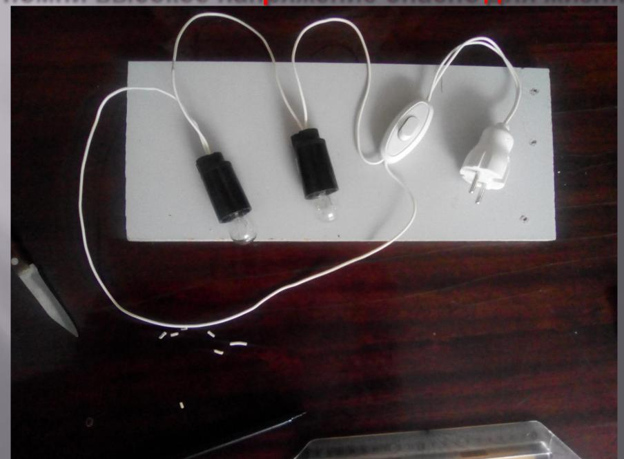
Последовательность практической работы «Монтаж электрической цепи»- параллельное соединение потребителей
