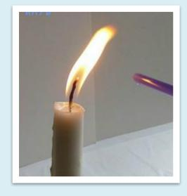
Опыт №4. Напротив трубки зажигаем свечу. Через трубку продуваем воздух, пламя свечи отклоняется в сторону трубки.
