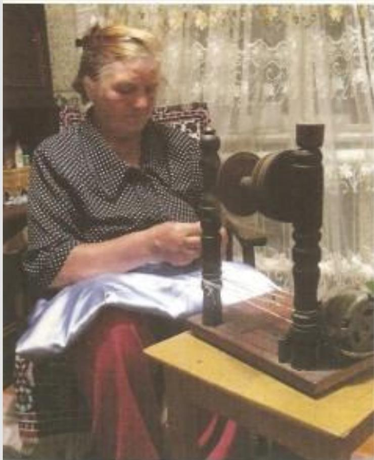
**При прядении нужно следить, чтобы толщина нити была равномерной, а сама нить перекручивалась не слишком сильно.**
