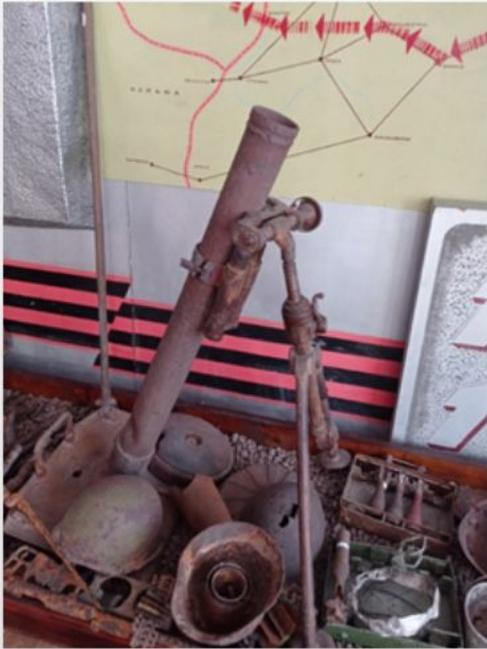
Миномёт – артиллерийское орудие, отличающееся отсутствием противооткатных устройств и лафета – их заменяет опорная плита, через которую импульс отдачи передаётся грунту или самоходному шасси (последнему – у самоходных миномётов).
