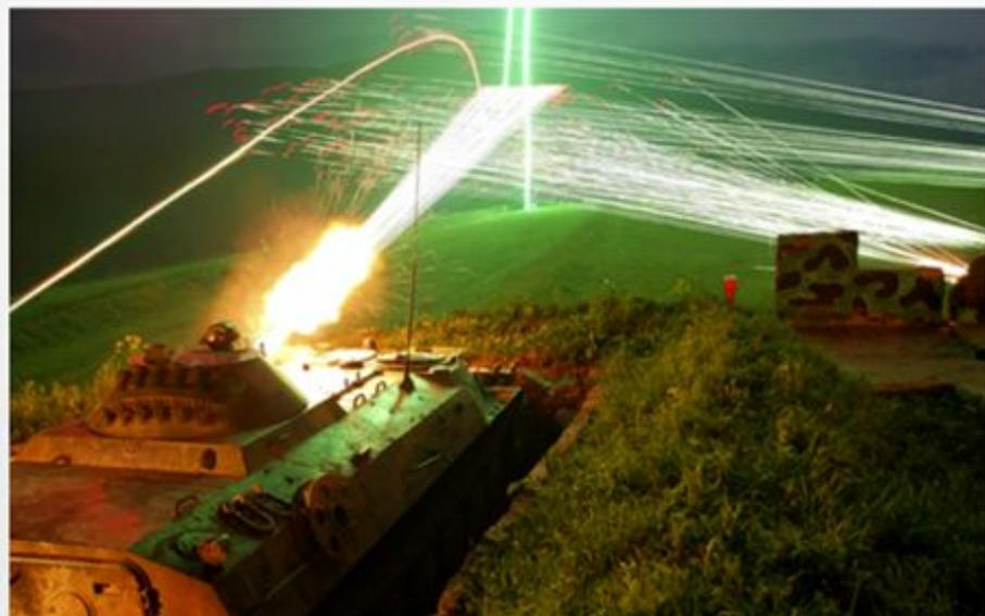
Трассирующий снаряд, трассирующая пуля, просторечие трассер— боевой припас особой конструкции к огнестрельному оружию, поражающие элементы (пуля) которого начинают светиться в полёте, создавая ясно видимый след (трассу, отсюда и название) для стрелка, предназначенный для корректировки огня и целеуказания.
