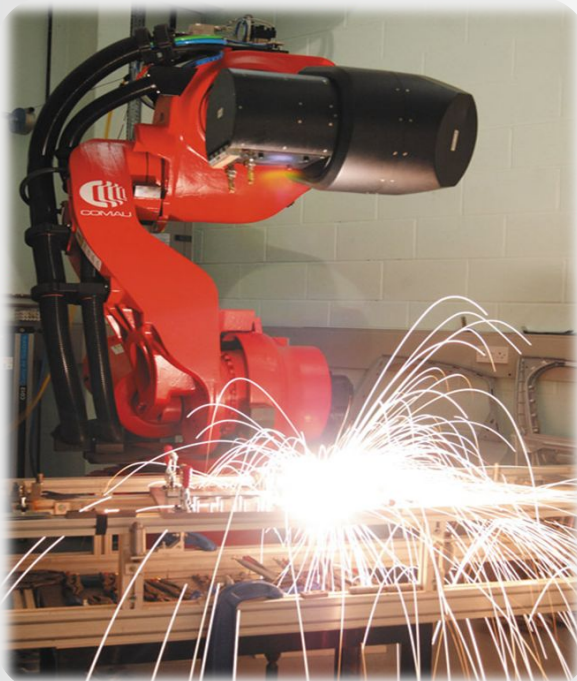
Процесс сварки с помощью ПР
