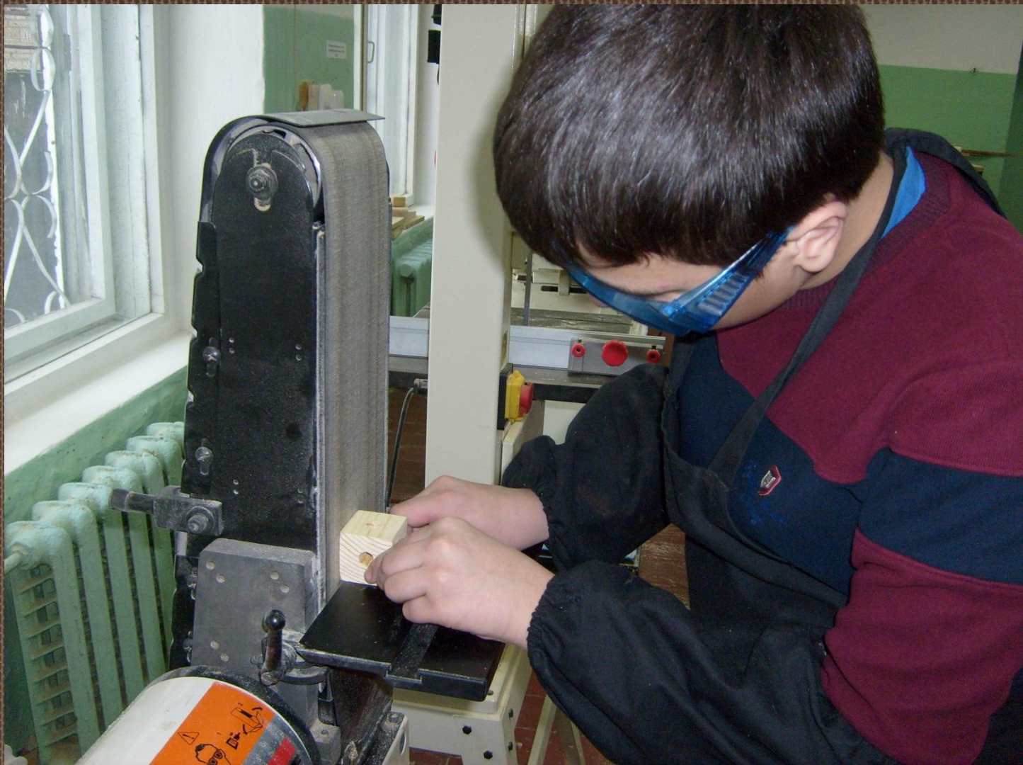
Обработка заготовки мелкозернистой шкуркой на шлифовальном станке.
