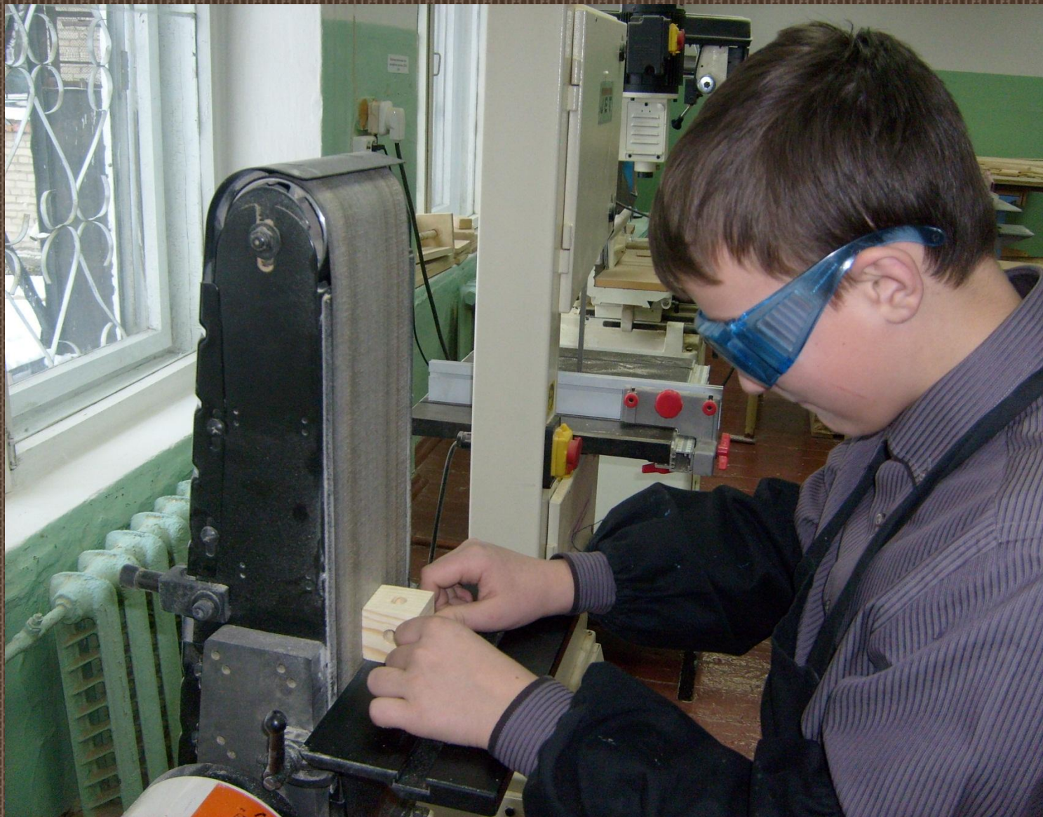
Устранение мелких неровностей на деталях
