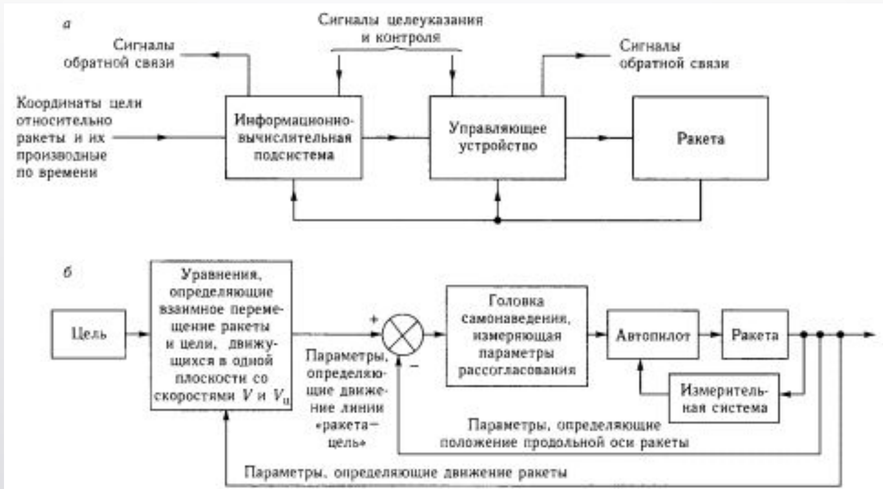
Рис. 1.1. Функциональные схемы системы самонаведения [3, 262]
