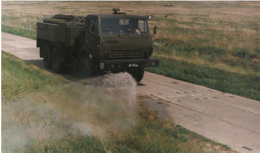
Авторазливочная станция АРС-14КМ развернута для пылеподавления обочин дорог
