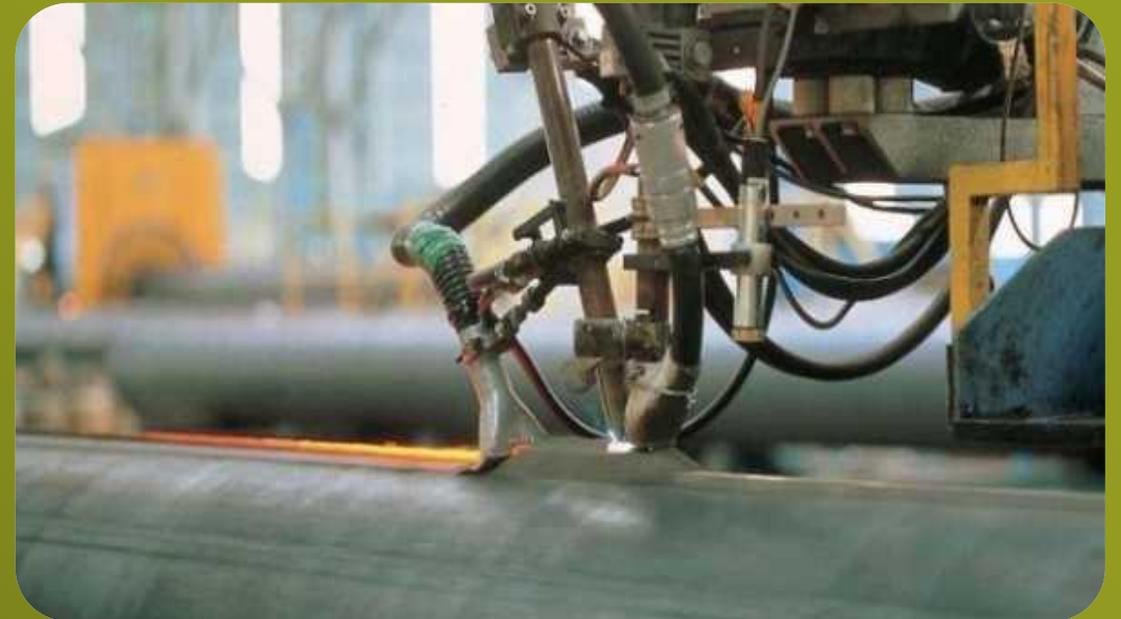
Если в конструкции сварочного автомата имеется тележка, перемещающаяся непосредственно по свариваемому изделию, то сварочный автомат называется **сварочным трактором**.
