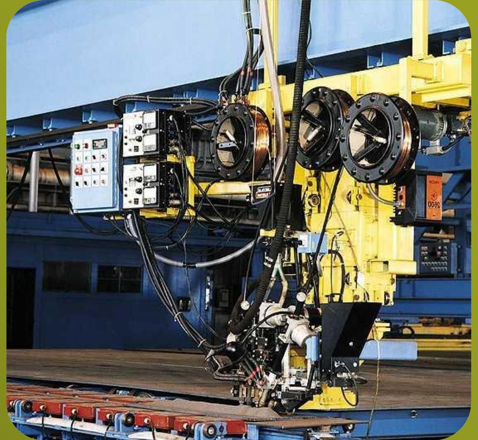
**Сварочная головка** называется **подвесной**, если она установлена неподвижно, а свариваемое изделие вращается или перемещается под ней.
