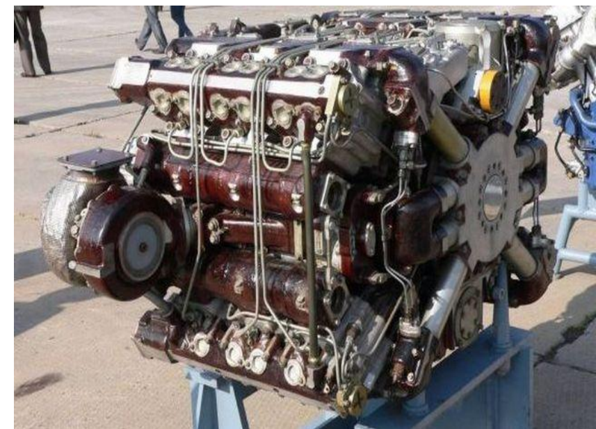
Дизельный четырехтактный, Х - образный, 12 - цилиндровый двигатель 12Н360
