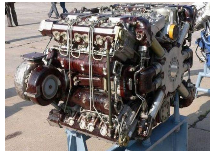
Дизельный четырехтактный, Х - образный, 12 - цилиндровый двигатель 12Н360
