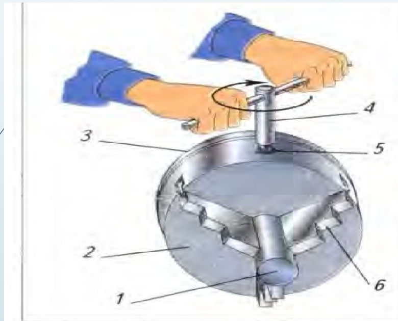
Рис. 68. Установка заготовок в трехкулачковый патрон: 1 — заготовка; 2 — корпус патрона; 3 — планшайба; 4 — ключ; 5 — отверстие под ключ; 6 — кулачки
