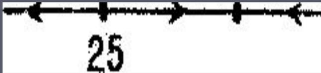
Линии электропередачи на металлических или железобетонных опорах (25—высота опоры в метрах)
