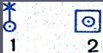
Колодцы: 1) с ветряным двигателем; 2) бетонированные с механическим подъемом воды.
