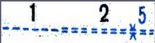
Сухие канавы: 1) шириной менее 3 м; 2) шириной 3 м; и более (5-ширина канавы в метрах)
