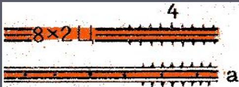
Автострады: 8—ширина одной полосы в метрах, 2—количество полос, Ц—материал покрытия (Ц—цементобетон, А—асфальтобетон); насыпи (4—высота насыпи в метрах)
