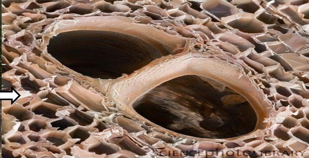
Структура древесины бальзы под микроскопом.
