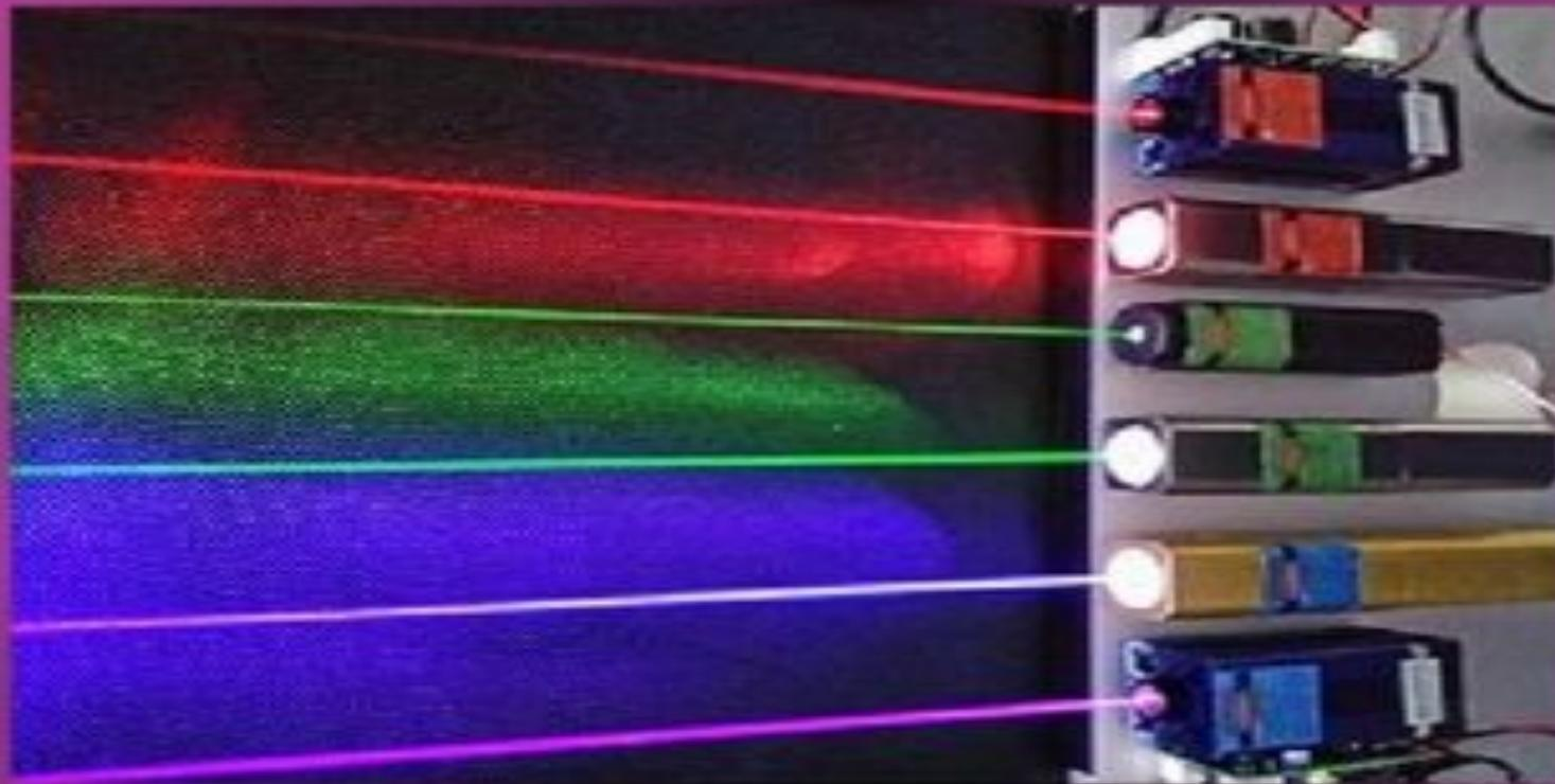
Лазерное излучение с длинами волн (снизу вверх): 405, 445, 520, 532, 635 и 660 нм.
