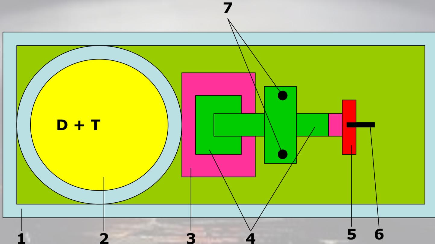
**1 – корпус боеприпаса с системой удержания плазмы в зоне реакции; 2 – смесь дейтерия и трития; 3 – отражатель нейтронов; 4 – заряд Pu-239; 5 – заряд ВВ; 6 – детонатор; 7 – источники**
