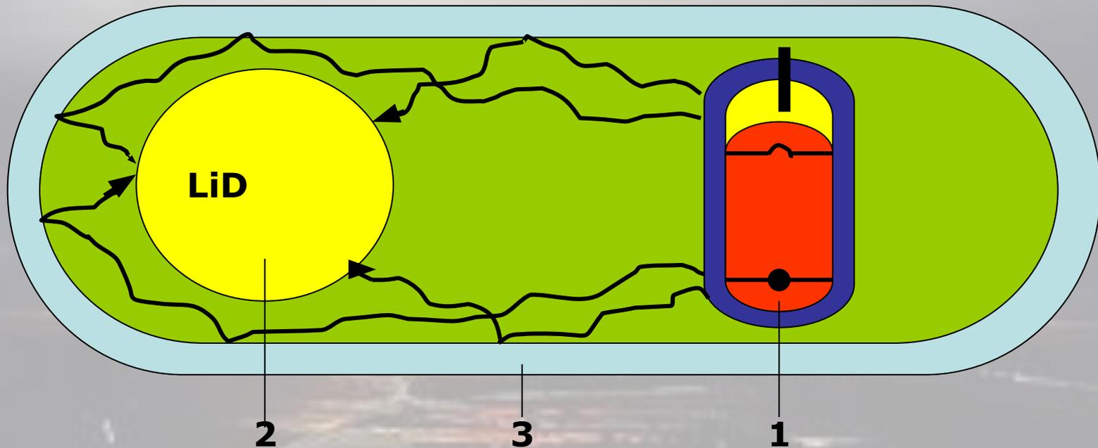
**1 – ядерный детонатор (заряд деления); 2 – заряд для реакции синтеза (дейтерид лития); 3 – корпус.**
