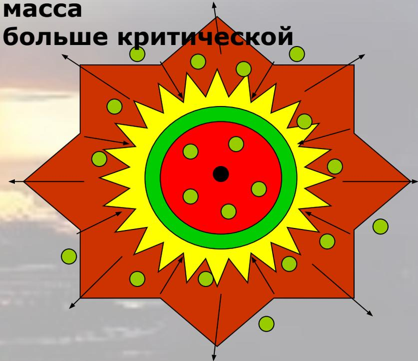
1 – детонатор; 2 – заряд ВВ; 3 – отражатель нейтронов;
