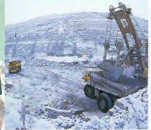
Мощные экскаваторы загружают алмазосодержащую породу в самосвалы грузоподъемностью 120–136 тонн.
