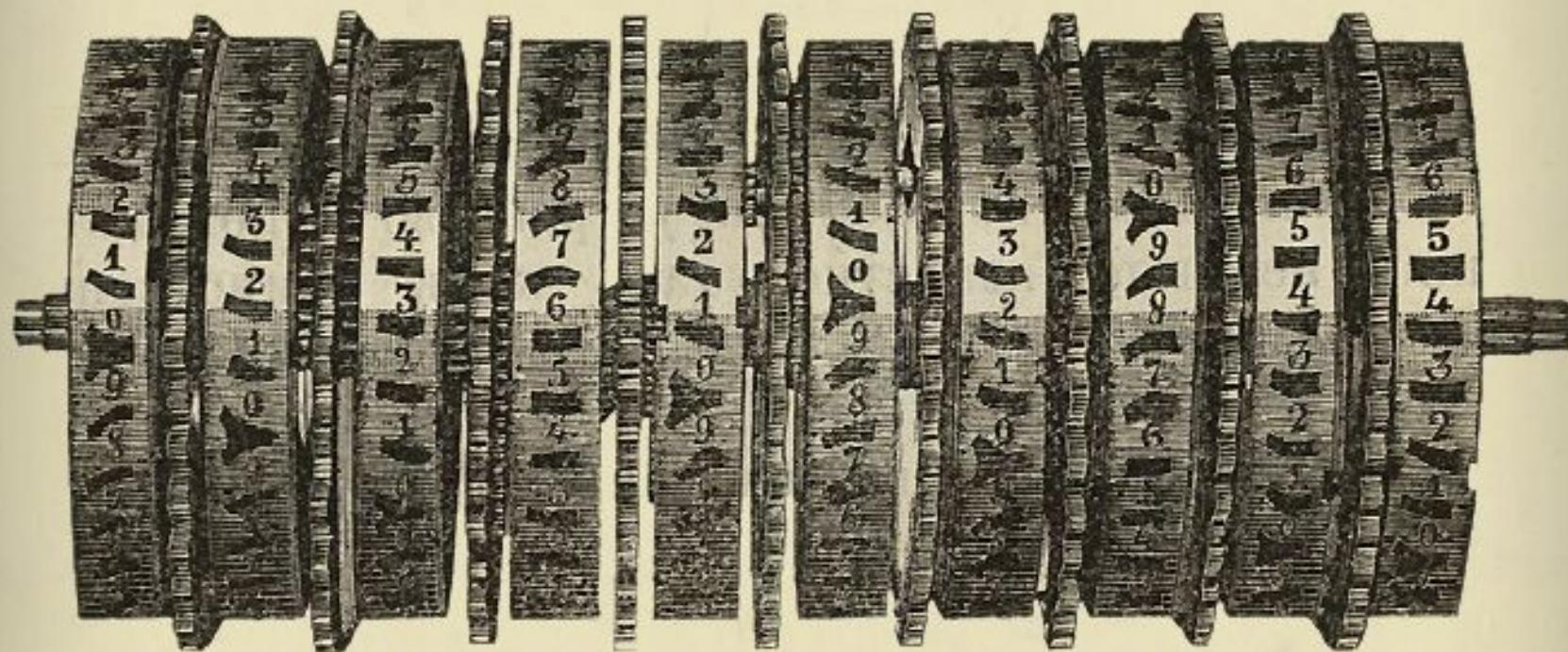
Ряд новых идей был воплощен и во множительно-делительном устройстве. Главная и наиболее плодотворная из них состояла в автоматическом переводе каретки из разряда в разряд. Кареткой, т. е. подвижной частью арифмометра, служила сама приставка. Для выполнения умножения и деления она устанавливалась на суммирующей машине, образуя с ней единый прибор. При выполнении умножения нужно было только вращать рукоятку арифмометра.
