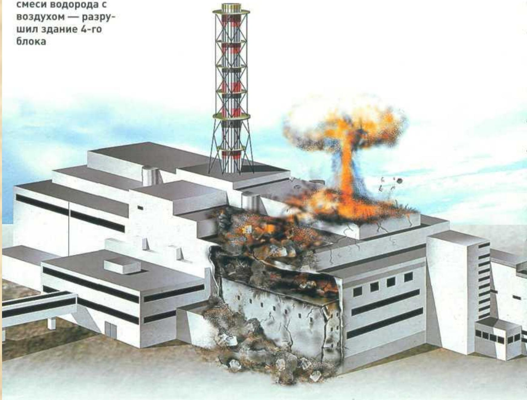
Взрывы привели к полному разрушению реактора и его активной зоны, систем охлаждения, а также здания реакторного зала. На крышу машинного зала, на территорию вокруг АЭС были выброшены железобетонные и металлоконструкции, графитовые блоки и их куски.
