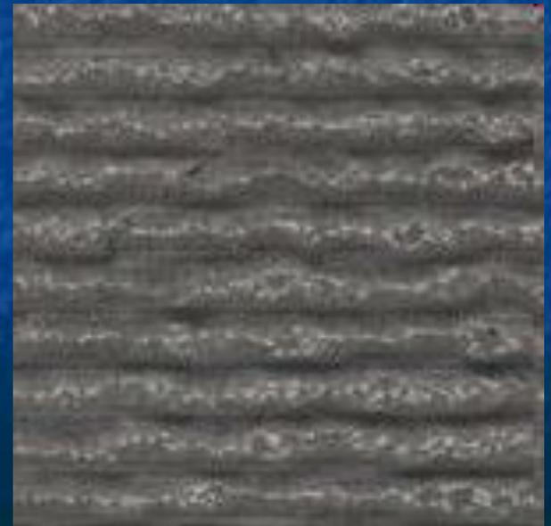
д) точечная фактура – равномерно шероховатая поверхность с точечными углублениями и высотой рельефа 0,5÷2 мм. Обрабатывают поверхность гранита, сиенита, габбро, диабаз.
