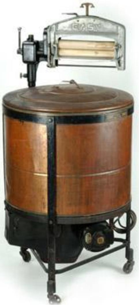
В 1920 - 1925 году появились первые бытовые стиральные машины. В цилиндрический резервуар заливалась вода, которая приводилась в движение одной или несколькими лопастями. С помощью электроэнергии осуществлялся и нагрев воды. Такие стиральные машины получили название, которое мы используем до сих пор - **машины активаторного типа**. Отжим белья осуществлялся через валики.
