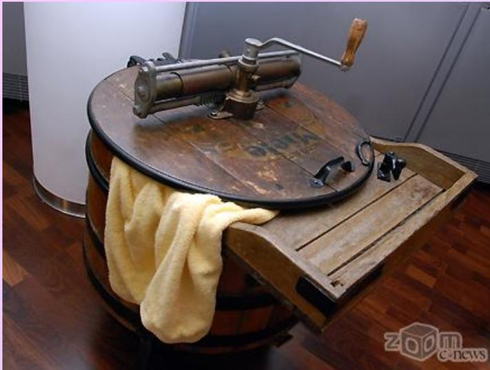
Первое изобретение ручной стиральной машины представляет собой, установленную на опорах деревянную кадку с мешалкой, которая приводилась во вращение с помощью рукоятки.
